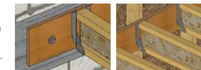
La muralière est chevillée au chaînage béton
