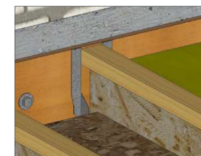
Solives fixées aux muralières par étriers IUSE
