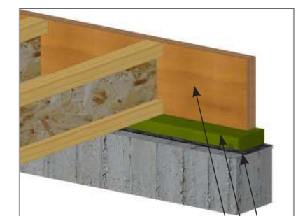
Pose en plateforme
