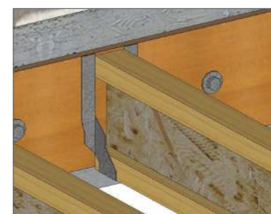
Muralière lamibois chevillée au chaînage béton
